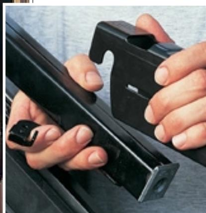
**8.** Engagez le châssis verticalement dans l'ouverture après l'avoir placé en position de nettoyage (poignée vers le haut et vers l'aval). Posez-le en appui sur ses ergots latéraux qui s'encliquent au bas du dormant.
